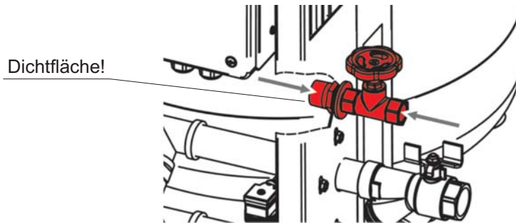
Abbildung 3: Montieren des Frischwasseranschlusses
